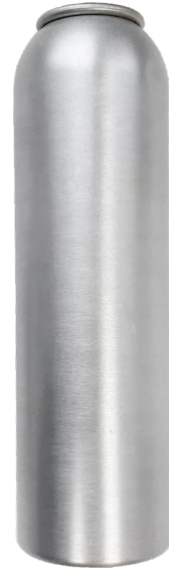
Diese Dose wurde aus einer höherfesten Neucan-Legierung gepresst, die noch dünnere Wandstärken ermöglicht. Unser Kunde TUBEX wurde 2021 für diese Idee mit dem deutschen Verpackungspreis ausgezeichnet.
